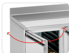
Portas com dobradiças de duplo efeito (fecho automático a &lt;math&gt;&lt;90^\circ&lt;/math&gt; e retenção automática a &lt;math&gt;&gt;90^\circ&lt;/math&gt;)
