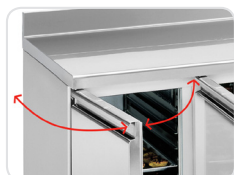
Portas com dobradiças de duplo efeito (fecho automático a <math><90^\circ</math> e retenção automática a <math>>90^\circ</math>)
